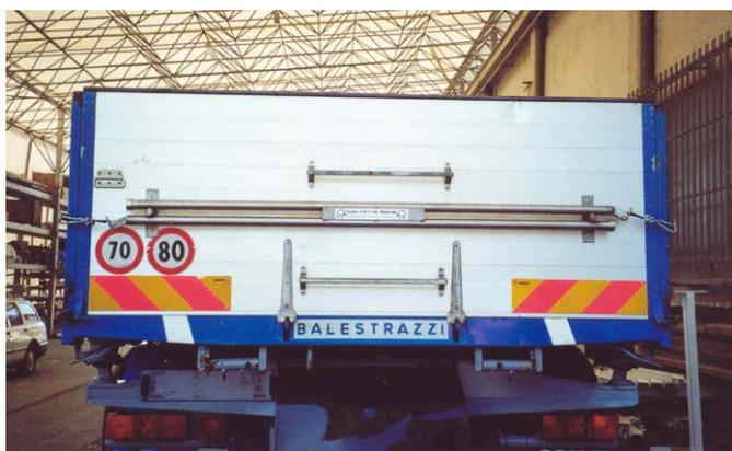
Si tratta di un sistema a compressione meccanica composto da 2 tubi in acciaio inox, cavo in acciaio zincato, staffe di fissaggio e molle a compressione. Concepito per agevolare le operazioni di apertura-chiusura delle sponde, ne elimina completamente in peso.
